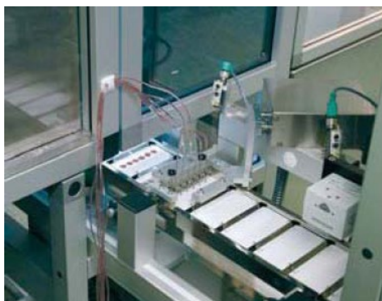
世界で初めて導入された精度管理コントロール検体自動作成装置 ろ紙への分注（左）、乾燥包装まで（右）を完全自動化します。
