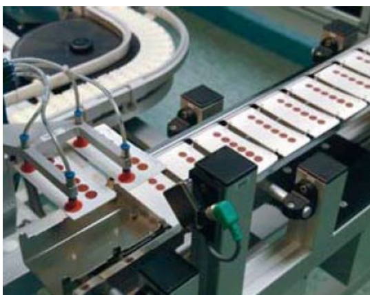
世界で初めて導入された精度管理コントロール検体自動作成装置 ろ紙への分注（左）、乾燥包装まで（右）を完全自動化します。
