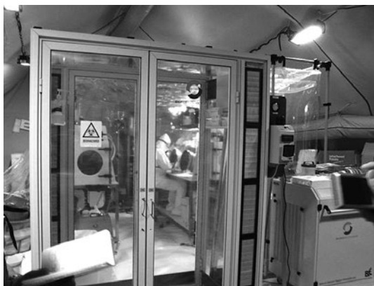
写真 8 フランス軍が運営する治療施設。空調の効いたテント内に、3時間程度で設営できる独自のP3施設を有している。RNAの抽出からRT-PCRまでテント内で一括して行い、4時間程度で結果を得ることができる。
