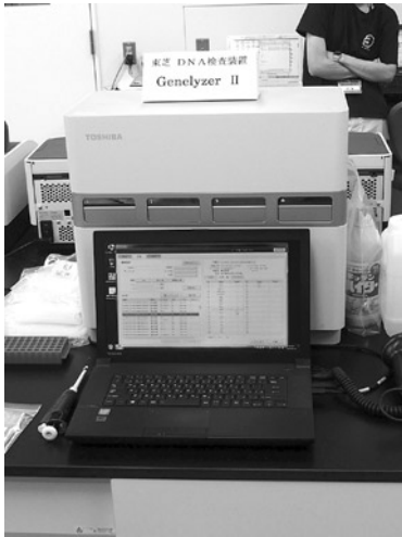
写真12 地元企業と共同で開発・製品化した食中毒菌DNAの検出装置
