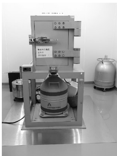
写真10 放射能検出装置（2トン近い重量のため床は補強がされている）
