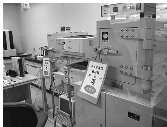
写真12 震災直後はこのゲルマニウム半導体検出器で様々な試料の放射線検査が行われた。この日は子供の尿の測定中とのことであった
