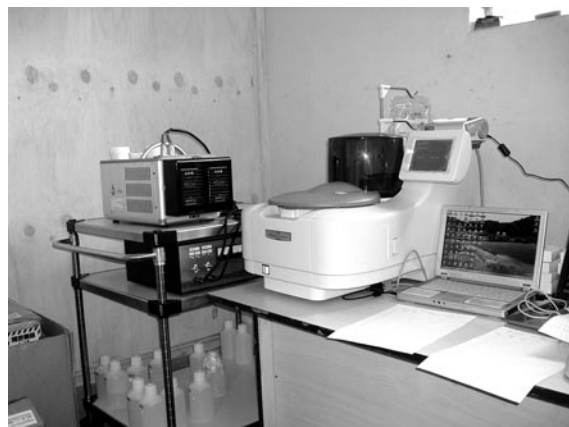
写真8 電気釜 S40 と燃料電池 電気釜の左側上段の白い機器が燃料電池
