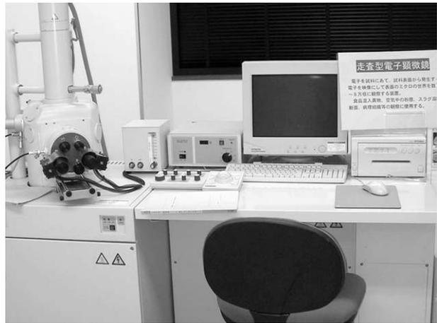
写真15 走査型電子顕微鏡。
