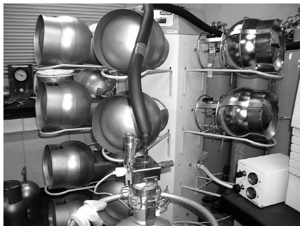
写真14 球形の容器に空気を集め、本機にセットして分析する。
