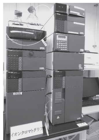
写真 22 大気課で用いているイオンクロマトグラフ。写真 21 と組み合わせて、六価クロムの分析を行っている。
