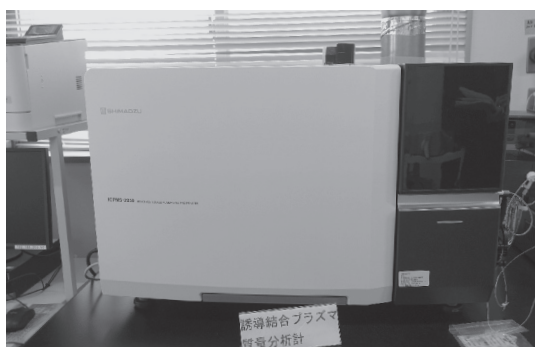
写真 21 大気課で用いている誘導結合プラズマ質量分析計（ICP-MS）
