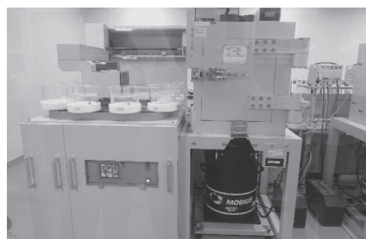
写真 23 測定中の \gamma 線スペクトロメーター（大気課）
