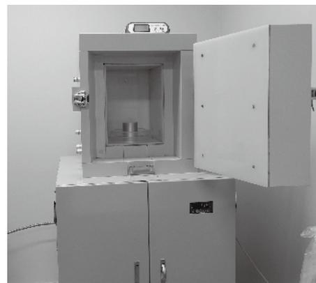
写真 16 ゲルマニウム半導体検出器付ガンマ線スペクトロメータ
