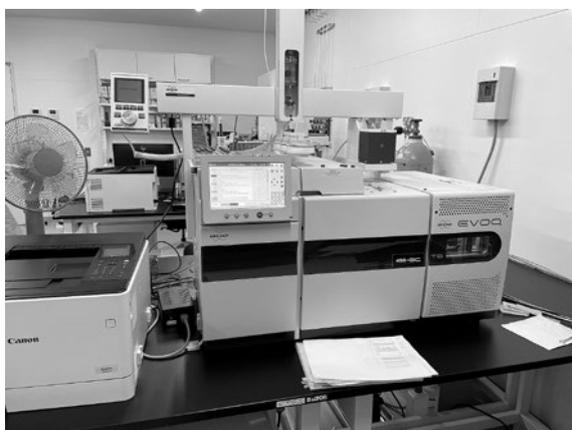
写真10 食品の残留農薬物等の検査に使用されるガスクロマト質量分析計
