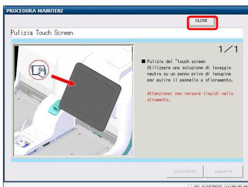
**3** Per visualizzare le procedure toccare il pulsante {Procedura}. Vengono visualizzate le procedure di pulizia.
