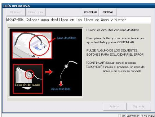
**10** Intercambiar la solución tampón y de lavado en el conducto con agua purificada (cuando "Exchange buffer and wash solution to purified water" está ajustado a "SÍ").
