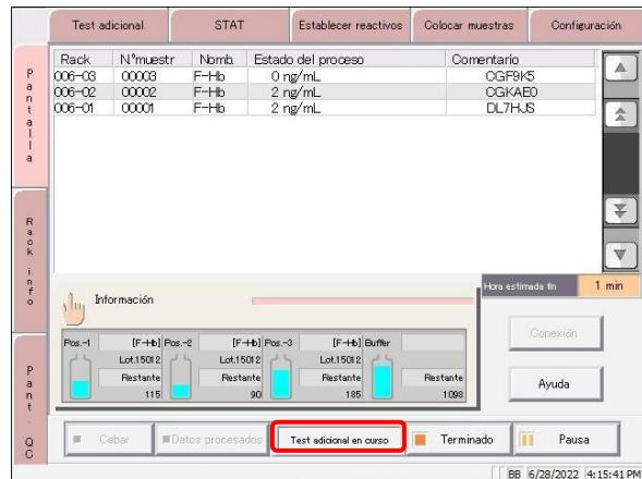
**Nota explicativa** : Cuando se ha configurado el número de *racks* y se ha suministrado el *rack* correspondiente, el mensaje "Testing adicional" cambia a "Running additional test". Una vez que se ha completado la prueba para todos los *racks* configurados, desaparece el mensaje "Running additional test".
