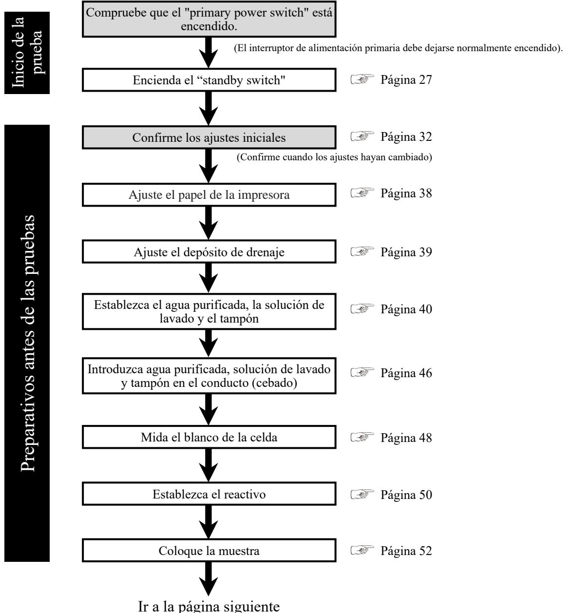
**Nota explicativa** : Si se marca "Cell blank" en "Auto start" en el modo de cierre, la medición del blanco de la celda se ejecutará automáticamente cuando se inicie el sistema.
