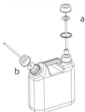
**3** Conecte un sensor de nivel cero (a) y una manguera (b) a cada puerto del depósito de solución de lavado (dos).
