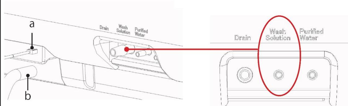
**4** Confirme que el sensor de nivel cero (a) y la manguera (b) están conectados a "Wash Solution" en el "installation location for tanks" en el lado izquierdo del sistema.
