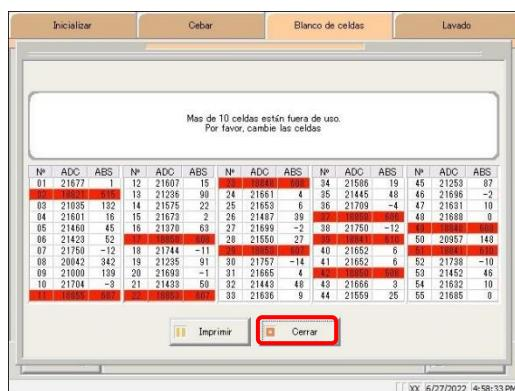
1 Las celdas de medición que no se pueden utilizar se muestran en rojo.
