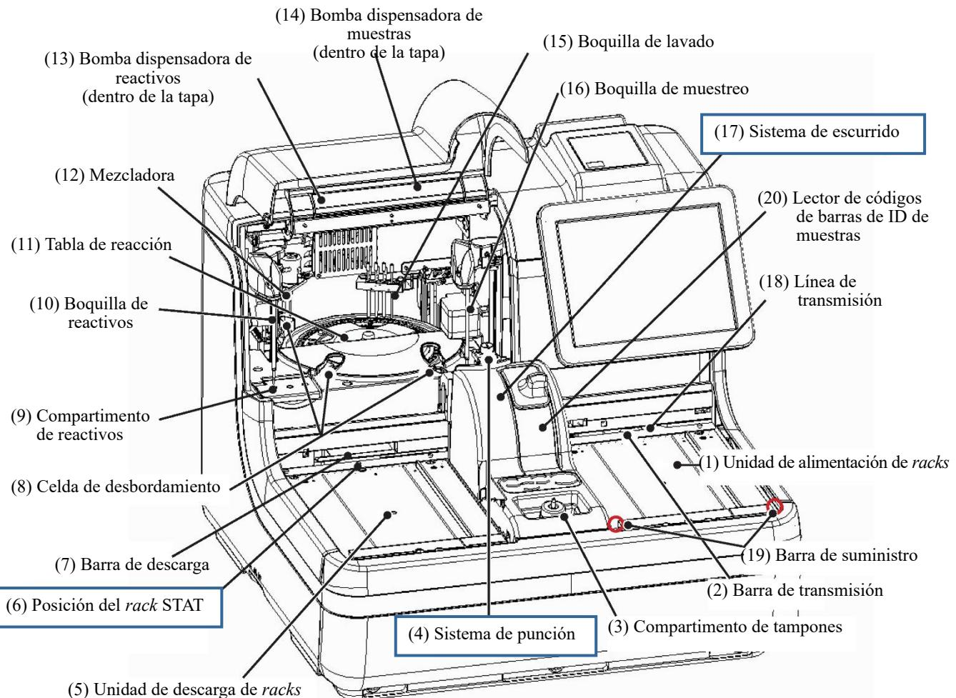
(6) Posición del rack STAT (ampliada)
