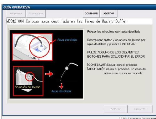
7 Intercambiar la solución tampón y de lavado en el conducto con agua purificada (cuando "Exchange buffer and wash solution to purified water" está ajustado a "SÍ").
