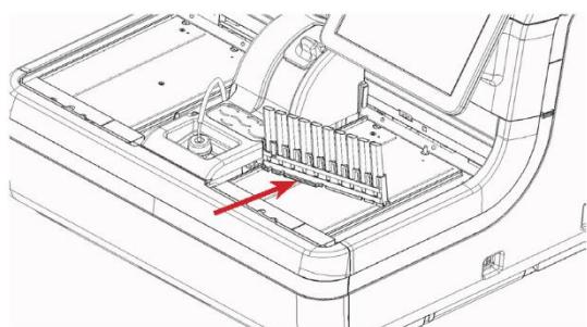
Coloque el *rack* en la unidad de suministro de *racks* con la posición de *rack* nº 1 en el lado izquierdo.
