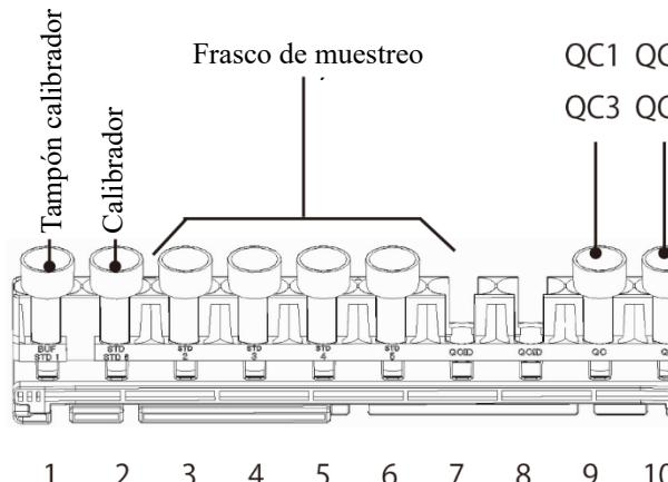
Coloque los frascos de muestreo en el *rack* STD/QC como se muestra en el diagrama de la
