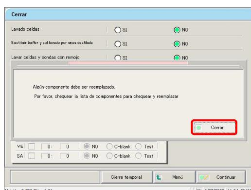
2 Si hay piezas para las que se ha superado el periodo de cambio, aparece "Some parts should be exchanged. Please check list of parts to check and exchange".
